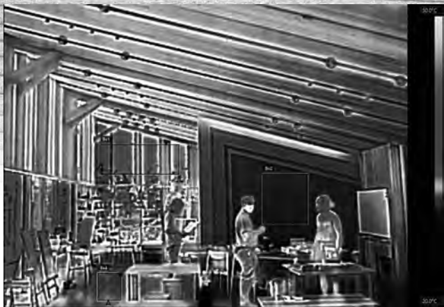
室内のサーモ画像(表面温度は天井35.1℃、西側ガラス窓33.5℃、中央の左官壁29.9℃、床31.5℃)
