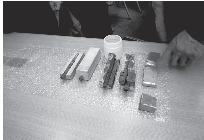
鉄筋への浸透性吸水防止材塗布の有無による違いが分かる
