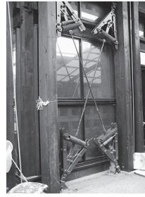
アンブレラ型制震装置
