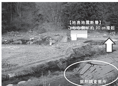
写真1: 白馬村塩島地区に出現した地表地震断層 (日本地震工学会調査団報告書に加筆)
