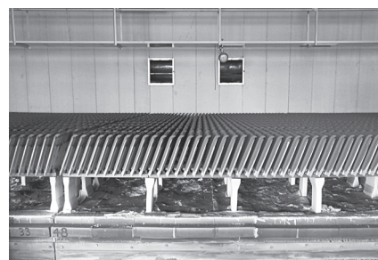
窯出し冷却中の平瓦
